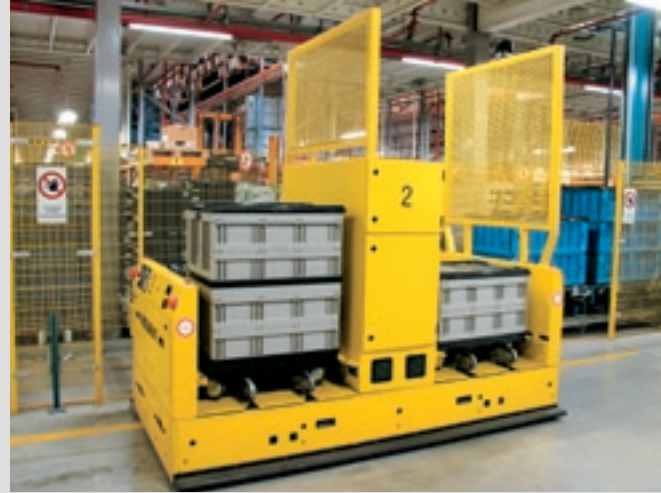
Automatischer Abtransport der Behälter vom Lager zur Versandabteilung
