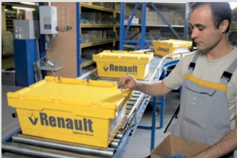
Sicheres Verschießen der Behälter mit 2 Steckplomben
