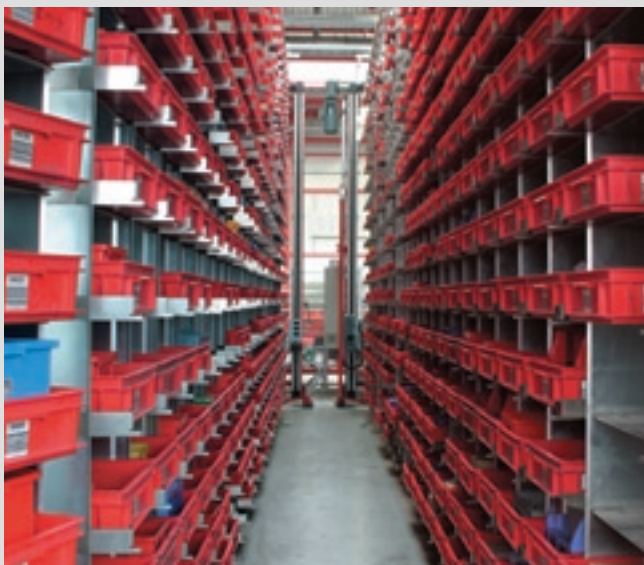
Zwischenpufferung der Ware im SCS (Schäfer Carousel System)
