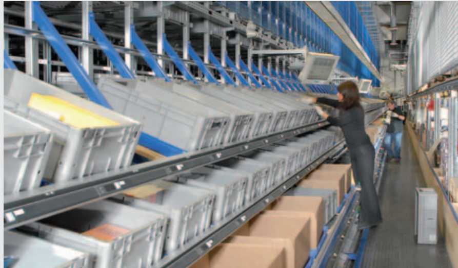
An den Kommissionierplätzen im AKL wird die Ware aus den Behältern oder von Paletten direkt in die Versandkartons oder -behälter kommissioniert.
