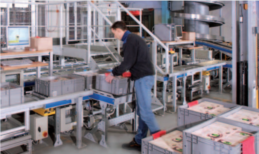
Die Wareneingänge für das AKL werden vor der Einlagerung in Behälter umgepackt.
