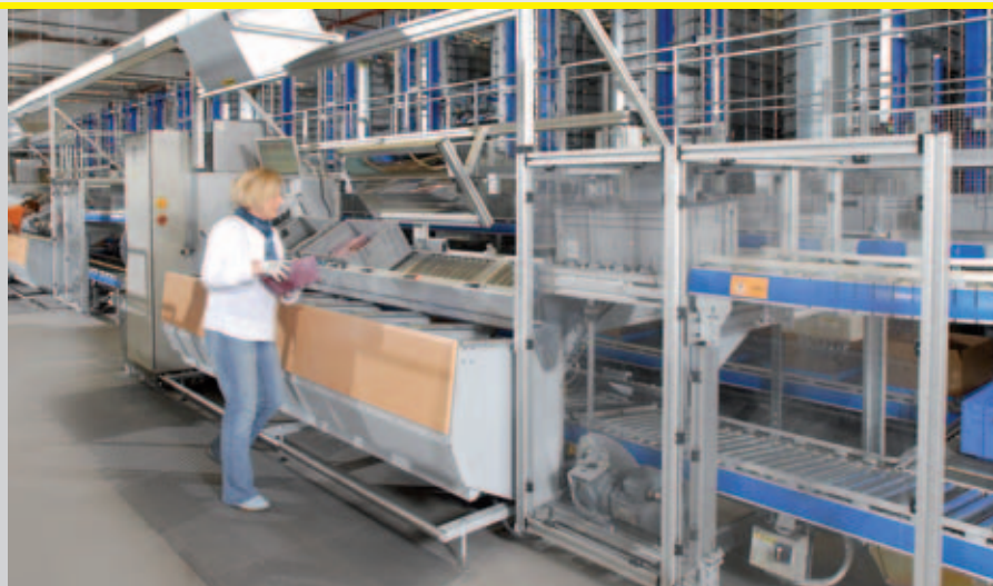
Ergonomische Arbeitsplatzgestaltung: Im SCS wird die aus den präsentierten Behältern entnommene Ware nach unten, in die Versandkartons kommissioniert.
