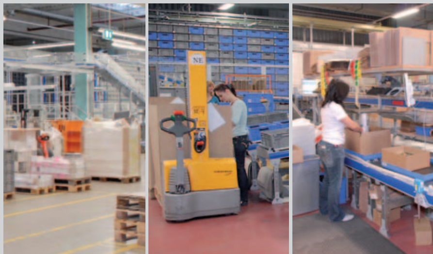
Warenausgang, Kommissionierung auf Palette, in Großkartons oder Verpackung von Kleinpackstücken direkt in Versandkartons.
