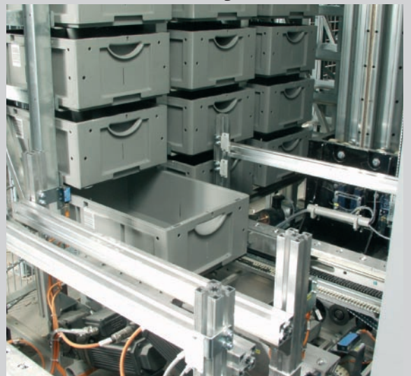
▲ Behälter Ein- und Auslagerung mittels Greif- und Ziehetechnik
