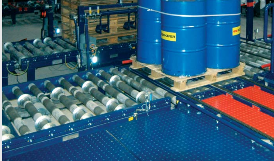
Fördertechnik Einlagerung, Palettenübergabe von der Rollenbahn auf den Kettenförderer
