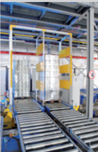
Zum Verladen werden die Paletten vollautomatisch von Verschiebewagen auf Rollenbahnen übergeben
