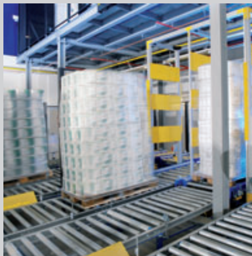
Zum Verladen werden die Paletten vollautomatisch von Verschiebewagen auf Rollenbahnen übergeben
