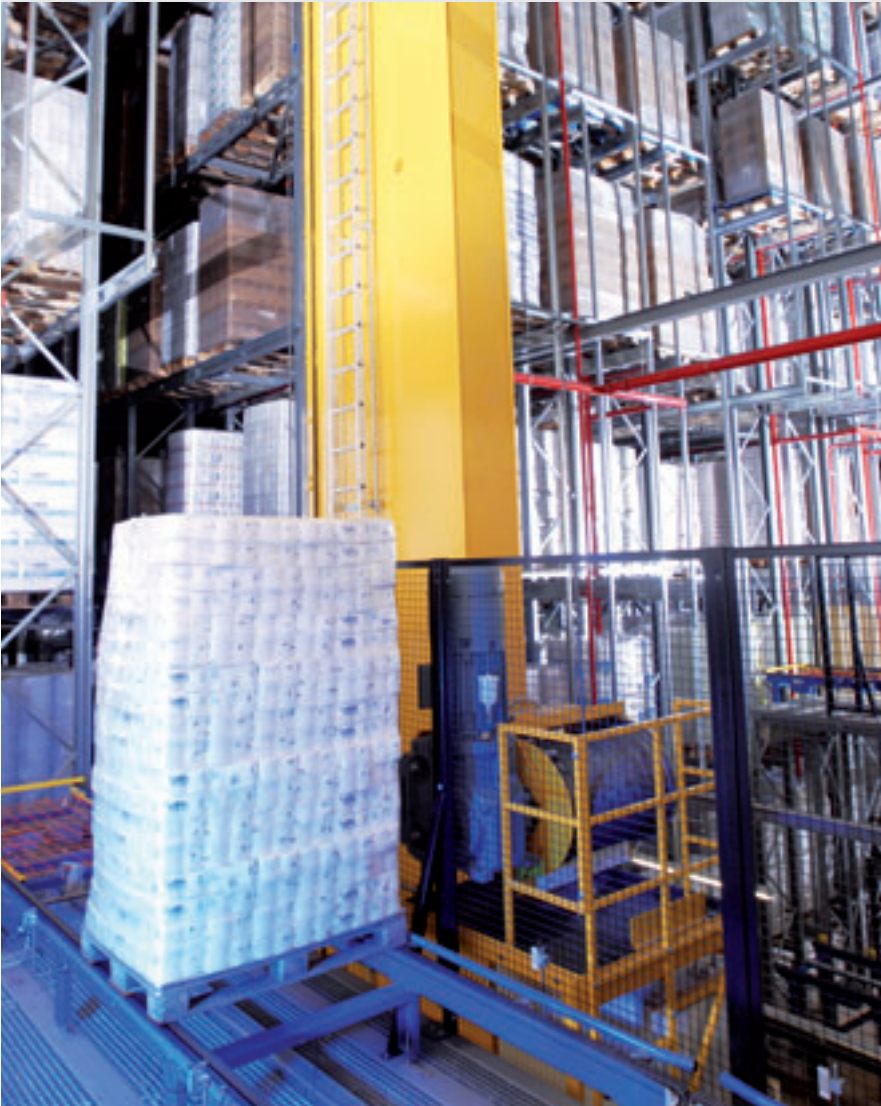
Palettierte Papierartikel werden auf 13 Ebenen von den RBG vollautomatisch eingelagert
