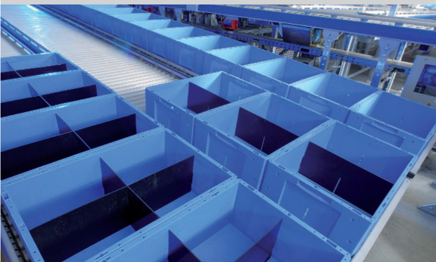
Automatische Verdichtung der robusten unterschiedlich unterteilten LTB von SCHÄFER
