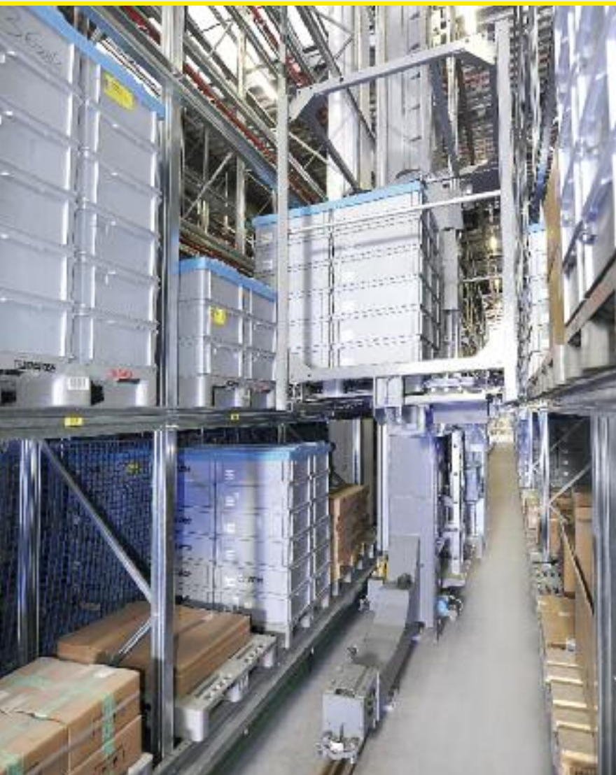
Im Hochregallager stehen 2.500 Stellplätze mit zwei unterschiedlichen Lagerhöhen und einer Tragkraft bis zu 700 kg zur Verfügung.
