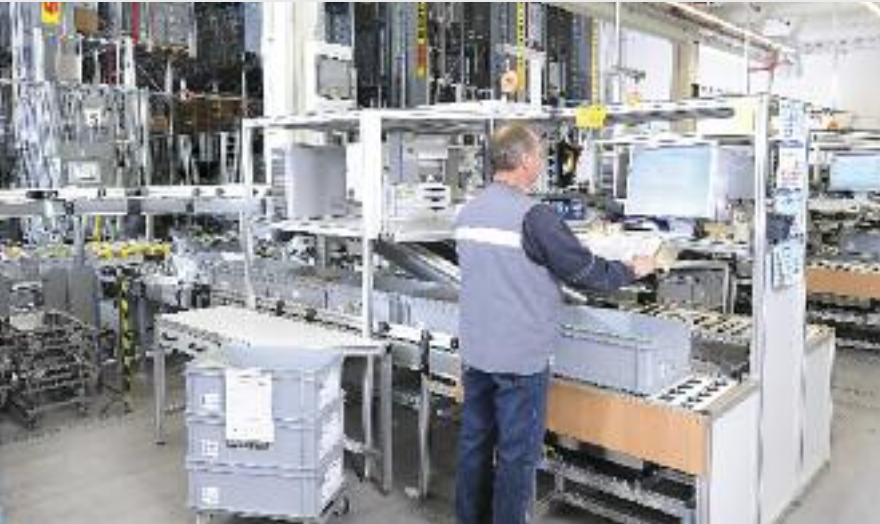
Ware zum Mitarbeiter – an den Umpackstationen wird nach Display-Vorgaben in Behälter gepackt.
