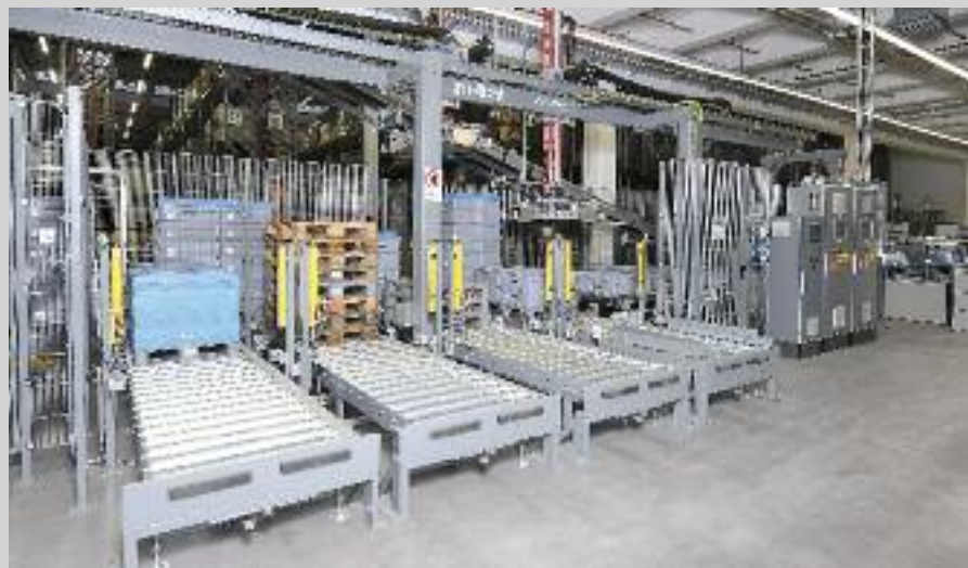
An der Aufgabestation werden täglich bis zu 7.000 palettierte Behälter in die Materialflüsse eingespeist.
