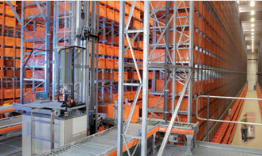
Nahezu 42.000 Behälterstellplätze stehen im AKL zur Verfügung.
