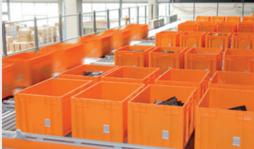
Über einen Sorter werden die Behälter zu den Kommissionierplätzen und wieder zurück zur Einlagerung ins AKL befördert.
