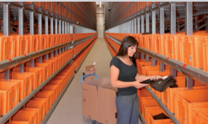
In den vier Kommissioniergassen für teilautomatisierte Kommissionierung bewegen sich die Kommissionierer mit Rollwagen durch das Lager.
