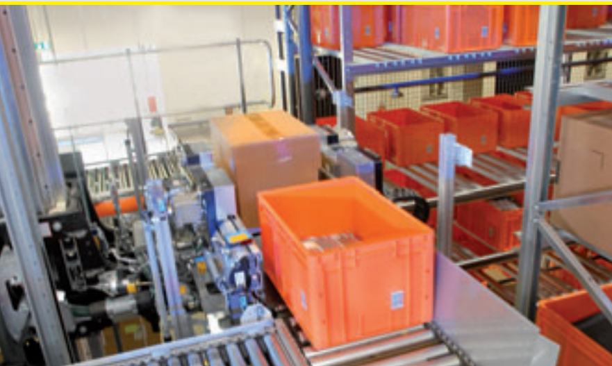
Mit einem Twister V Lastaufnahmemittel können die RBG zwei verschiedene Ladeeinheiten doppelt tief ein- und auslagern.
