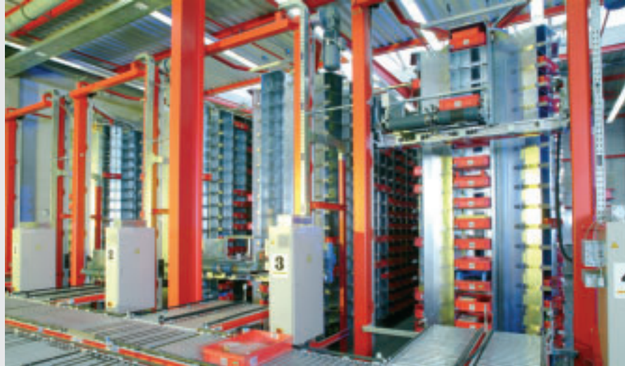
Vier Karussellspeicher stellen die Waren auf die Förderanlage
