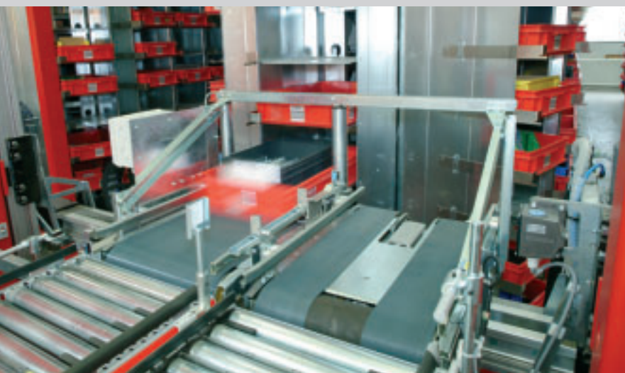
Übergabe vom Heber auf die Förderanlage
