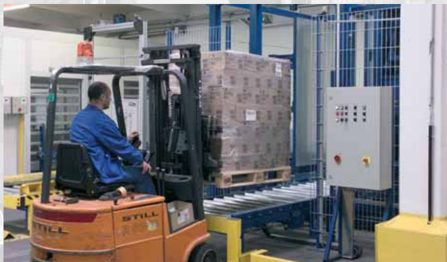
Palettenauf- und Abgabestation Wareneingang
