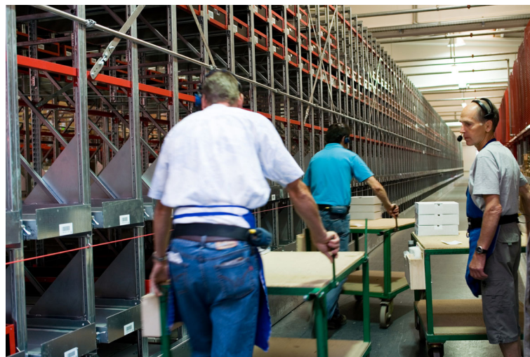
Bild 2: Pick by Voice Kommissionierung
