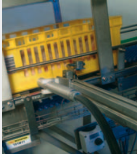
Die Systembox mit Lüftungsschlitzen für die Kühlzirkulation wird vom Inkjetdrucker während der Beförderung beschriftet.
