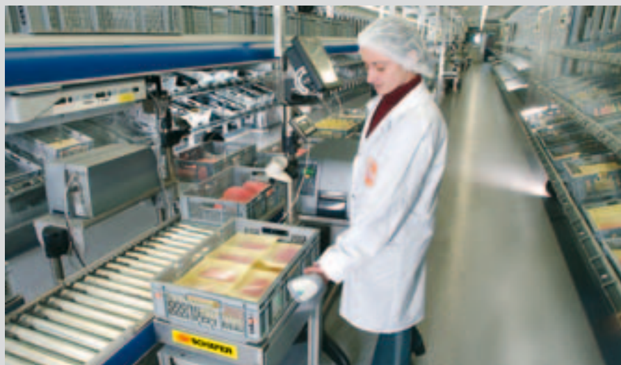
Pick by Light Kommissionierung im Fertigwarenlager
