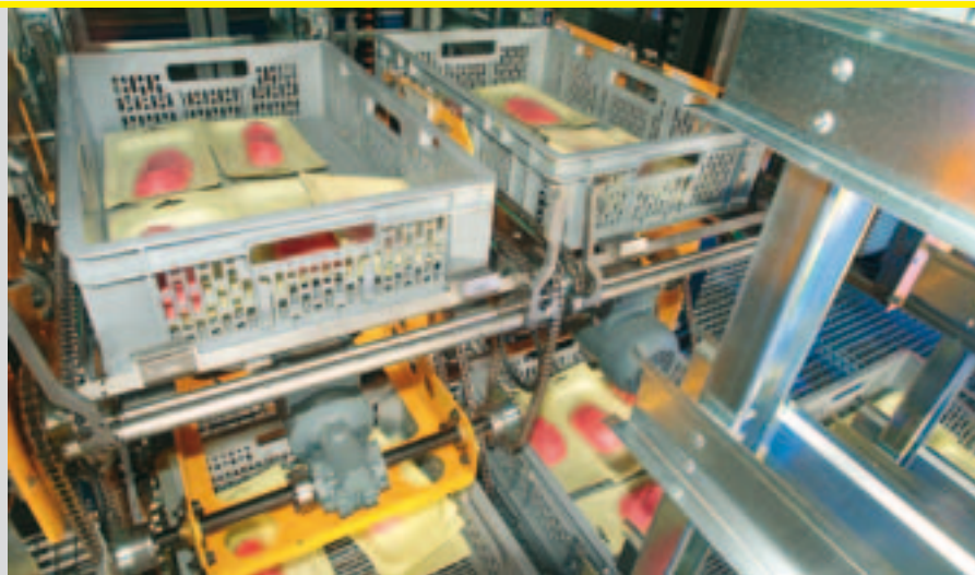
Transport der Versandbehälter durch Lastaufnahmemittel des SQS mit 4facher Ziehvorrichtung
