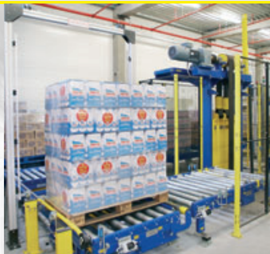
An den 3 I-Punkten werden Palettenkontur, Gewicht und Daten der Transporteinheiten mit den Systemdaten abgeglichen
