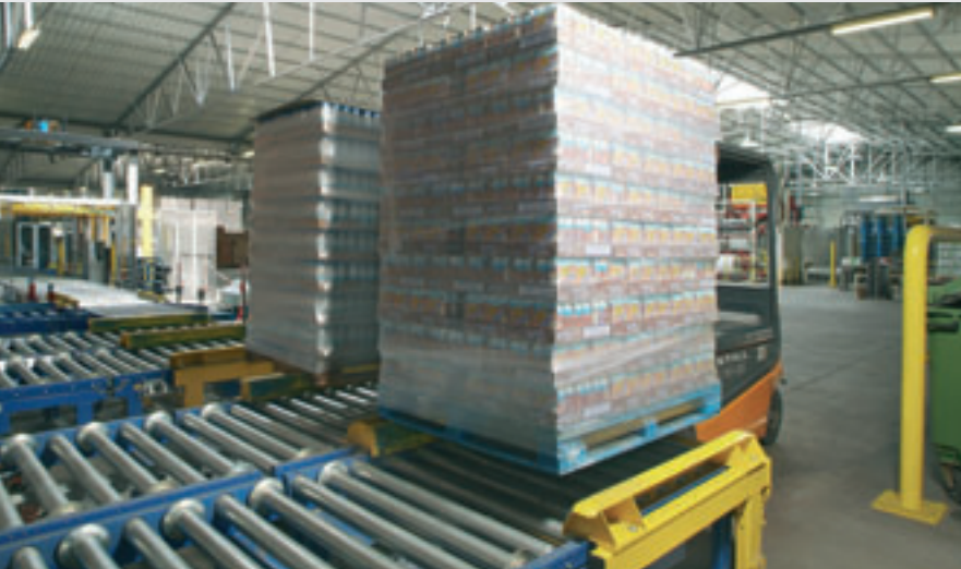
Stapler mit Doppelpalettengabel übergibt zwei Paletten gleichzeitig an die Fördertechnik
