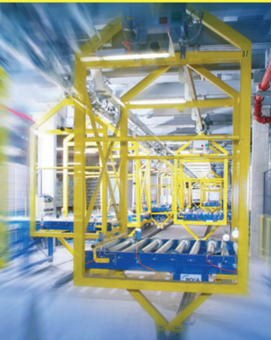
Elektrohängebahnen führen die Paletten auf einem ovalen Rundkurs zum Warenausgang
