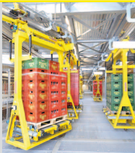
Knapp 280 Gondeln hängen an den Führungslinien der Elektrohängebahn zwischen Produktion und Lager. Streckenlänge insgesamt 4 km.
