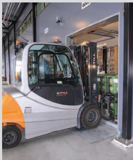
Bei der Verladung werden Stapler mit drei Lastaufnahmegabeln eingesetzt, die 3 Paletten gleichzeitig verladen.
