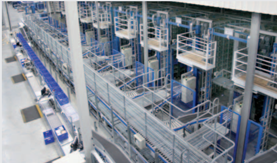
SCS-Anlage aus 18 Karussellen zur automatischen Kommissionierung
