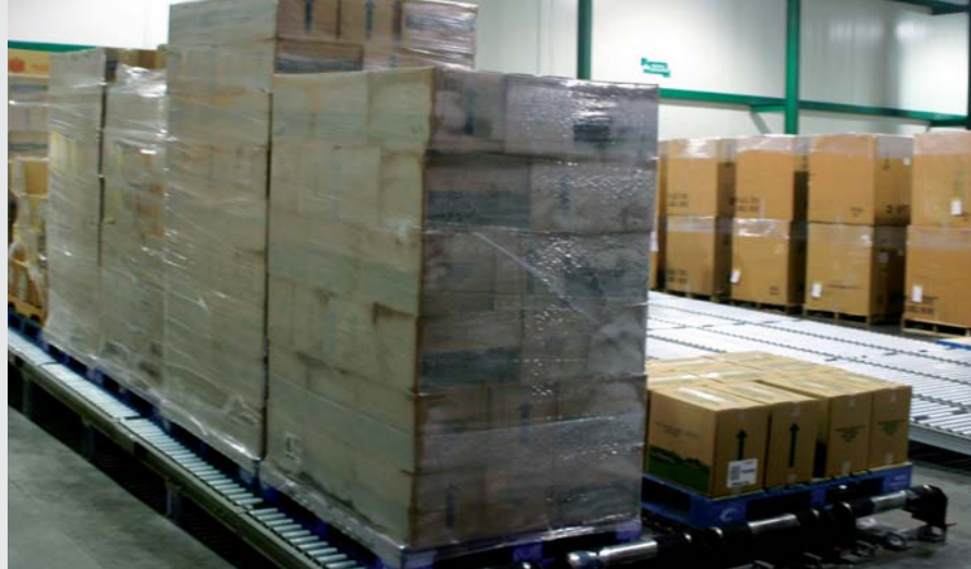
Gefällerrollenbahn im Warenausgang
