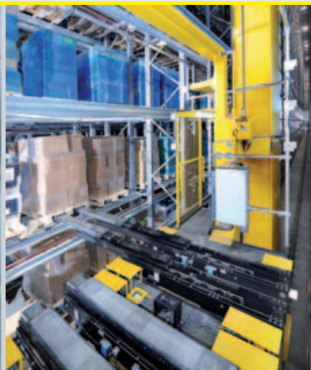
RBG mit vier Teleskopgabeln für gleichzeitige Aufnahme von 2 Euro- oder einer Bigbox-Palette
