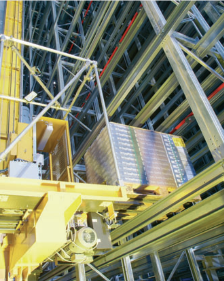
Regalbediengerät bei der Einlagerung einer Palette
