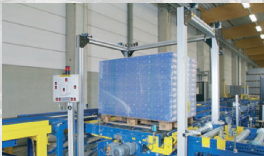
Konturenkontrolle, Palettenidentifikation und Gewichtsermittlung am Leitstand
