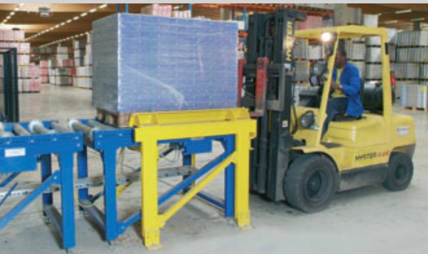
Wareneingang von der Produktion mittels Frontstapler oder fahrerlosem Transportsystem
