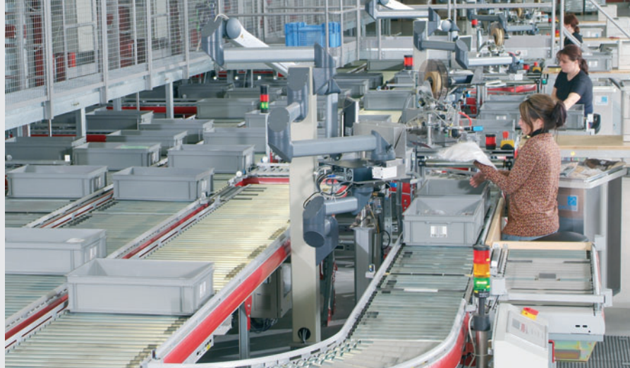
SCS Fördertechnik und Kommissionierbereich mit RFID Behälteridentifizierung
