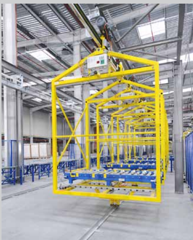
Gehänge der Elektrohängebahn
