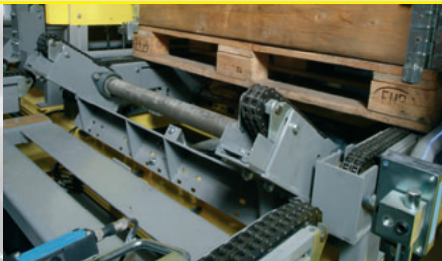
Klappstück für sicheren Palettentransport
