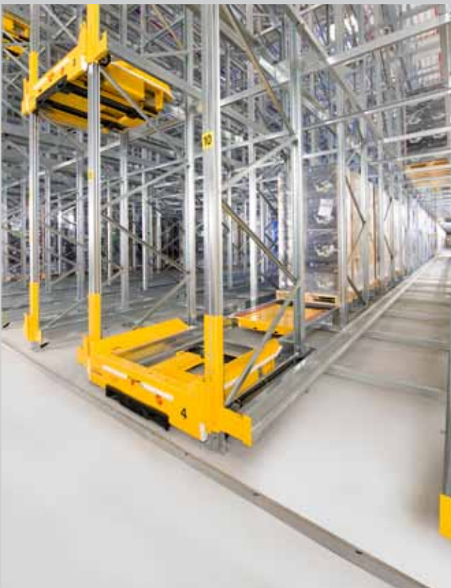
Blick in ein Kanal mit Schäfer Orbiter System
