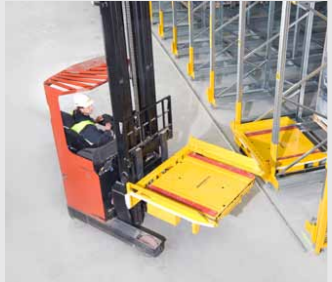
Sicheres und präzises Einheben der Docking Station
