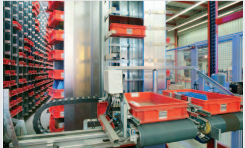
Behälterentnahme und vertikale Beförderung mittels stationärer Hebeteknik. Der Wegfall von Regalbediengeräten ermöglicht den geringen Abstand zwischen den Karussellen und spart so jede Menge Platz.
