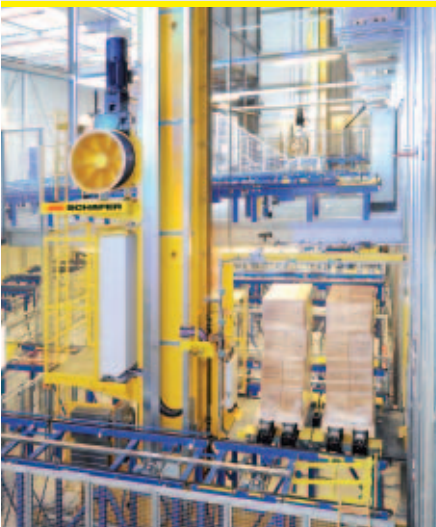
RBG mit vier Teleskopgabeln für gleichzeitige Aufnahme von 2 Euro- oder einer Bigbox-Palette
