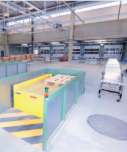
Vakuumlifter, hydraulische Scherenhubtische, Rollen- und Teleskopförderer sind die Ausstattung für ergonomisch gestaltete Arbeitsplätze im Wareneingang.
