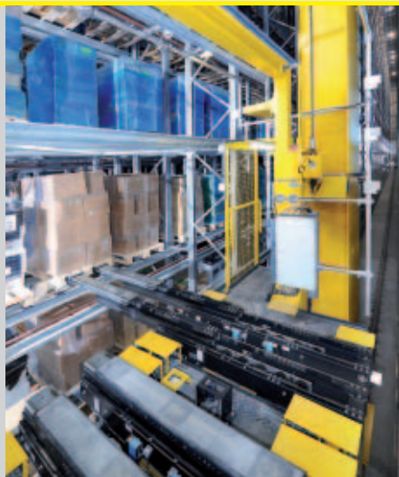
RBG mit vier Teleskopgabeln für gleichzeitige Aufnahme von 2 Euro- oder einer Bigbox-Palette
