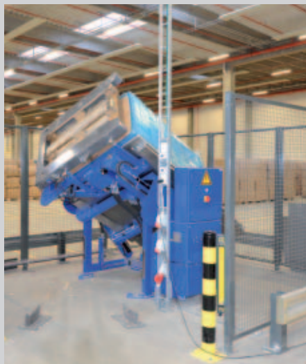
Vollautomatischer Austausch schadhafter Paletten
