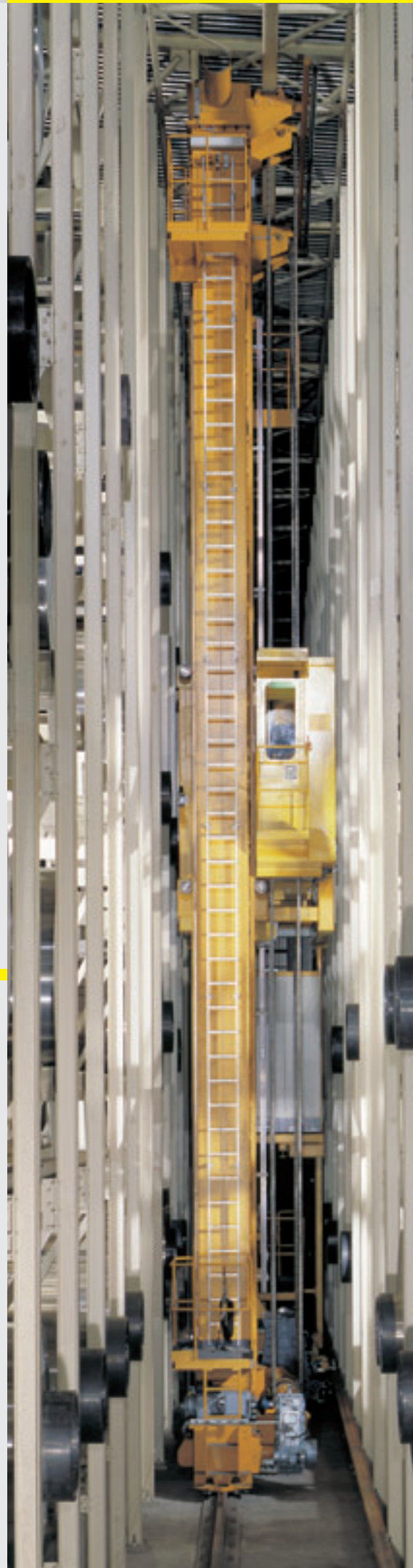
Zwischenlagerung für Aluminium-Coils (11 to)
