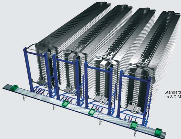
Behälterentnahme und vertikale Beförderung mittels stationärer Hebeteknik. Der Wegfall von Regalbediengeräten ermöglicht den geringen Abstand zwischen den Karussellen und spart so jede Menge Platz.
